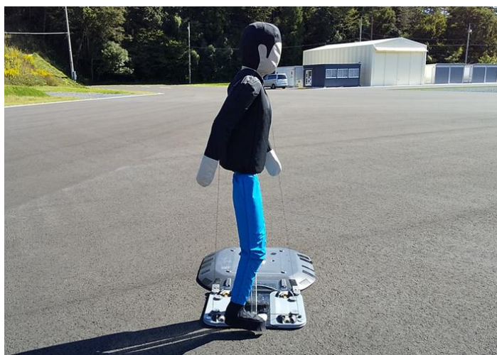
付図 A 試験用ターゲットの外観
