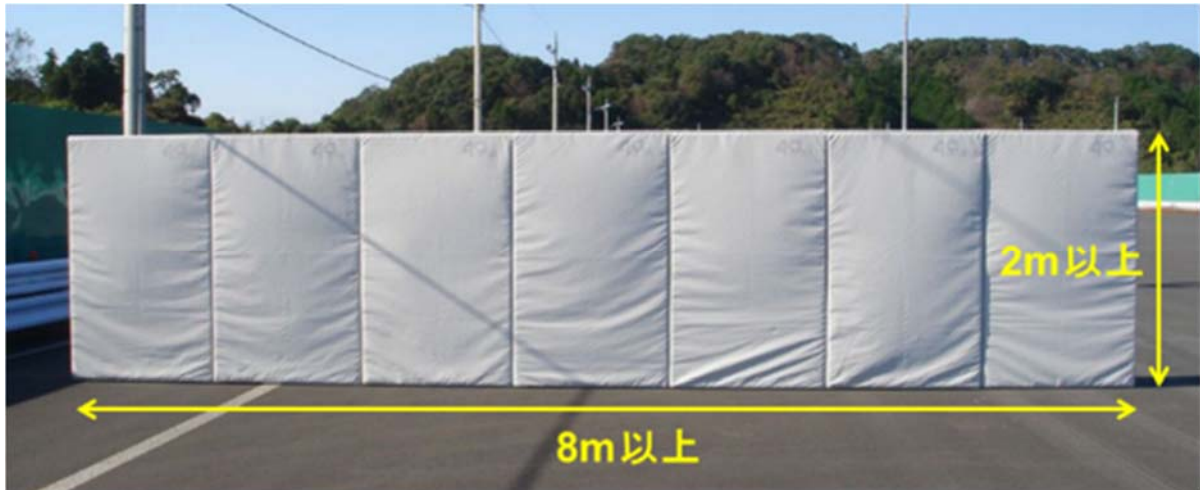
付図 B 遮蔽壁の外観と必要寸法
