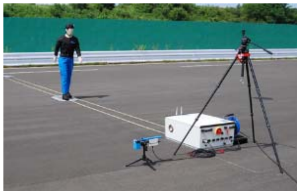
(b) 試験用ターゲットのドライブユニット 付図 A 試験用ターゲットの外観
