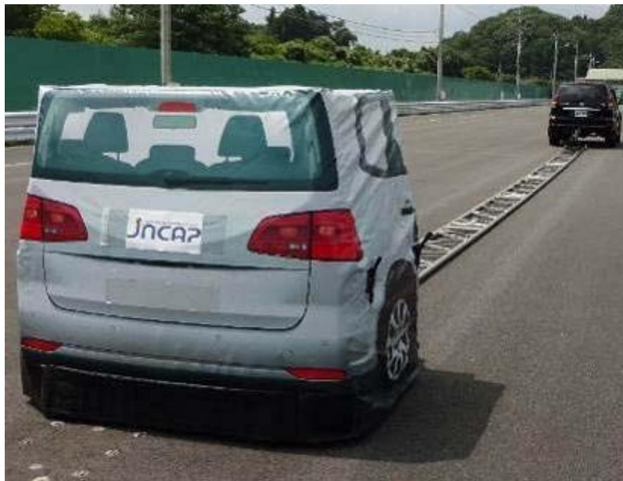
付図 1 試験用ターゲットの外観
