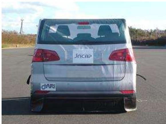
付図1 試験用ターゲットの外観
