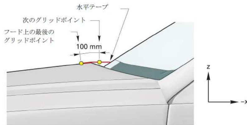
図 3.10 外部輪郭の下のグリッドポイント (車両中心線上までの例)
