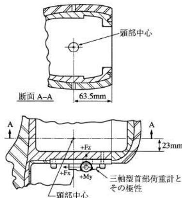
図15 6軸型首部荷重計取付状況
