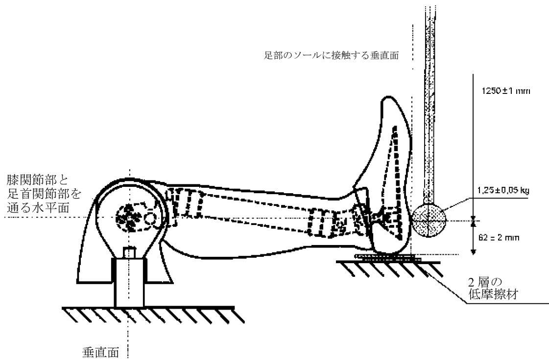
図12 下足部衝撃試験（靴付き）（試験装置仕様）
