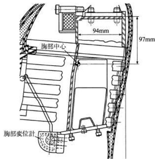
図17 胸部加速度計感度中心
