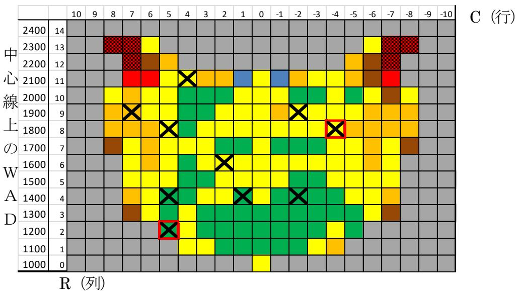
C, 2, +5グリッドについては結果が予測データに対してHIC<sub>15</sub>許容公差内であるため、補正係数算出時は自動車製作者等提示の色（得点）を使用する。
