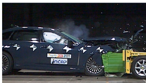
新オフセット前面衝突試験済み車両と台車
