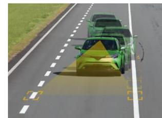
（車線逸脱抑制装置のイメージ）
