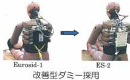
2. 新たな側面衝突試験法開発に向けて、カーテンエアバッグ装着の有無により、対ポール側面衝突試験の有効性について検証を行った。
