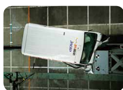
オフセット(部分) 前面衝突試験
