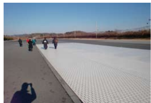
【圧雪路を模擬した低 \mu 路】
